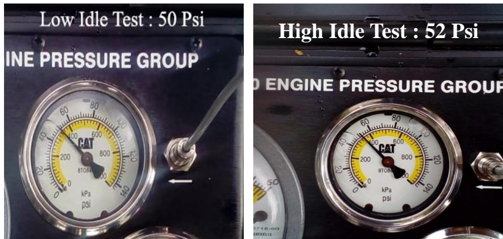
Gambar.7 hasil pengukuran tekanan oli
