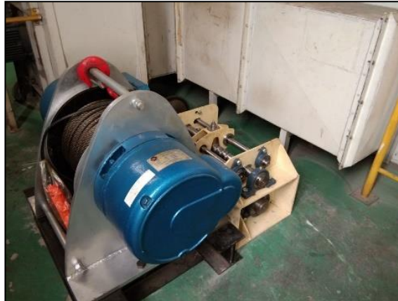
Gambar 3.4 Hasil modifikasi Electric winch di PT.X
