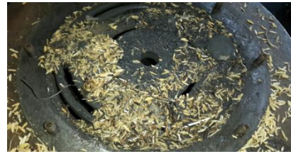
Gambar 5. Sisa sekam yang menyumbat Reaktor
