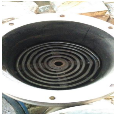
Gambar 7. Kondisi Reaktor setelah dilakukan cleaning
