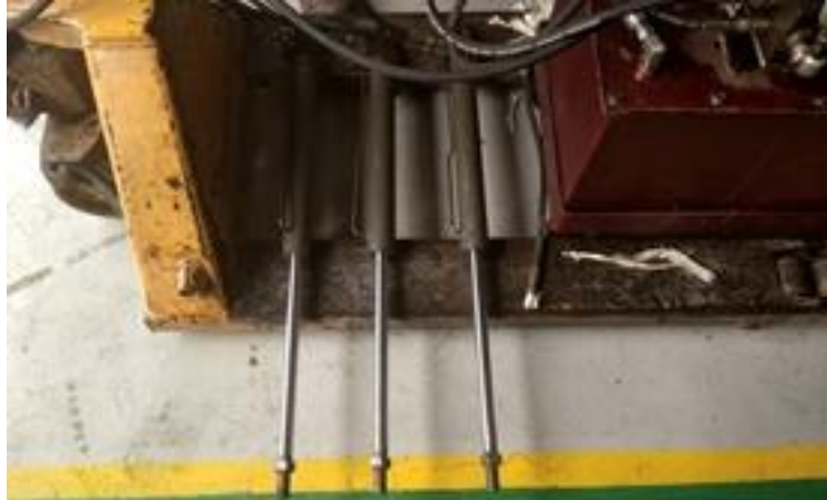
Gamabr.7 Kondisi ketika cylinder hydraulic actuator pada posisi rangkain parallel mencapai posisi maksimal
