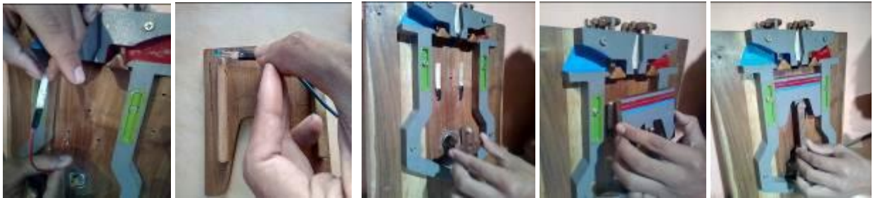
Gambar 26. Pemasangan Komponen Elektrik , Crankshaft , Piston dan Connecting Rod
