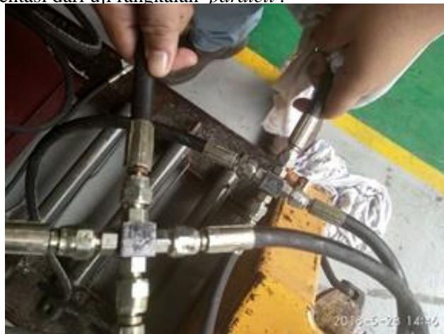
Gambar.6 Kondisi awal rangkaian parallel menggunakan fitting untuk membagikan fluida
