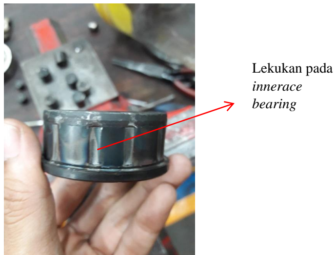
Gambar 5 Bearing yang mengalami Brinelling
