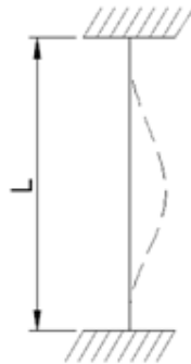
Gambar.10 Pelendutan pada profil kolom
