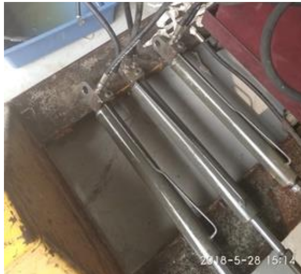
Gambar.10 Kondisi Cylinder Hydraulic Actuator Rangkaian Kombinasi saat Maksimal
