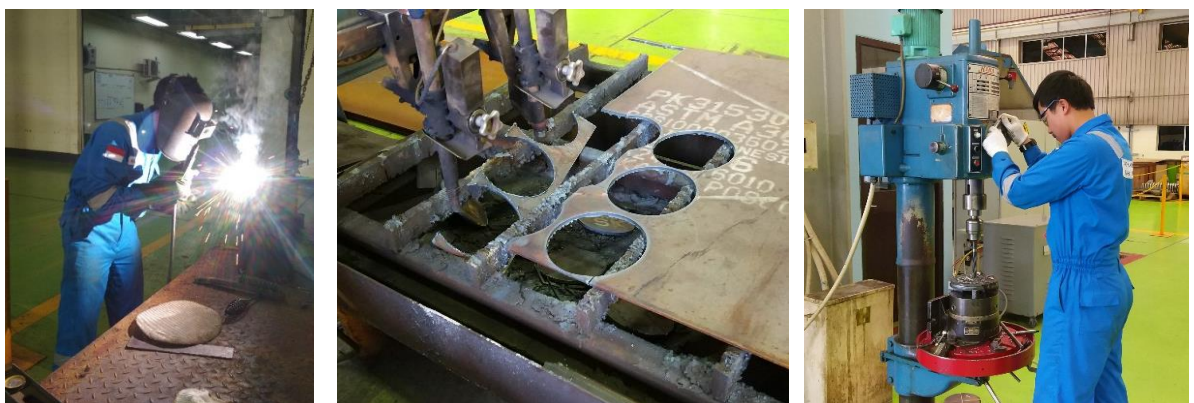
Gambar 2 Proses fabrikasi meliputi (dari kiri ke kanan): pengelasan, plasma cutting, machining.
