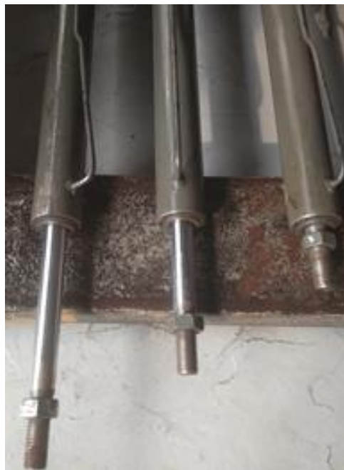
Gambar.4 Kondisi Rangkaian Series ketika cylinder hydraulic actuator mencapai posisi maksimal
