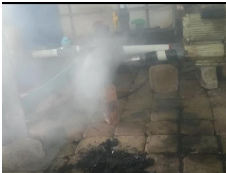
Gambar 1.Indikasi adanya kemacetan pada Gasifier karena syngas yang berkurang
