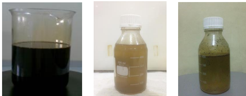
Gambar 4 Hasil pengujian alat (dari kiri ke kanan: limbah gliserol, gliserol hasil pemurnian 1, gliserol hasil pemurnian 2)
